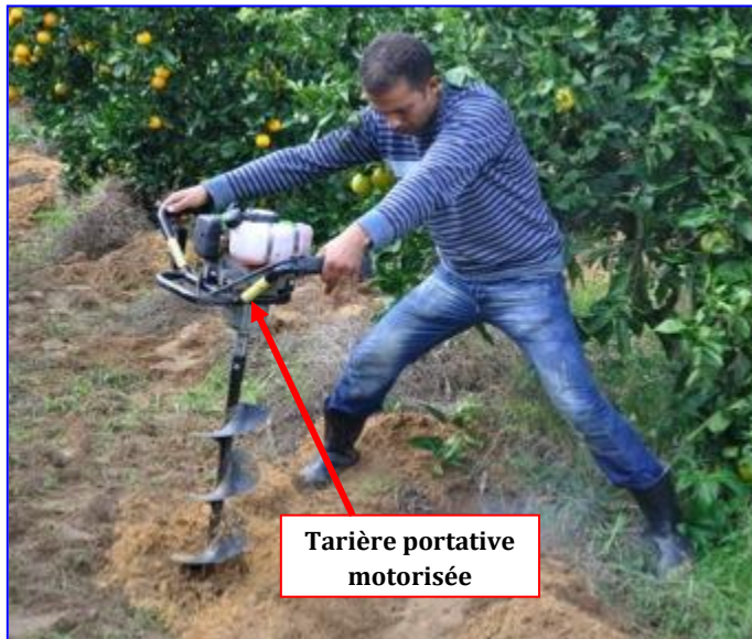
Utilisation d'une tarière portative motorisée pour le creusage des trous des diffuseurs pour les orangers d'une exploitation à Beni Khalled, Cap Bon Nord de la Tunisie
