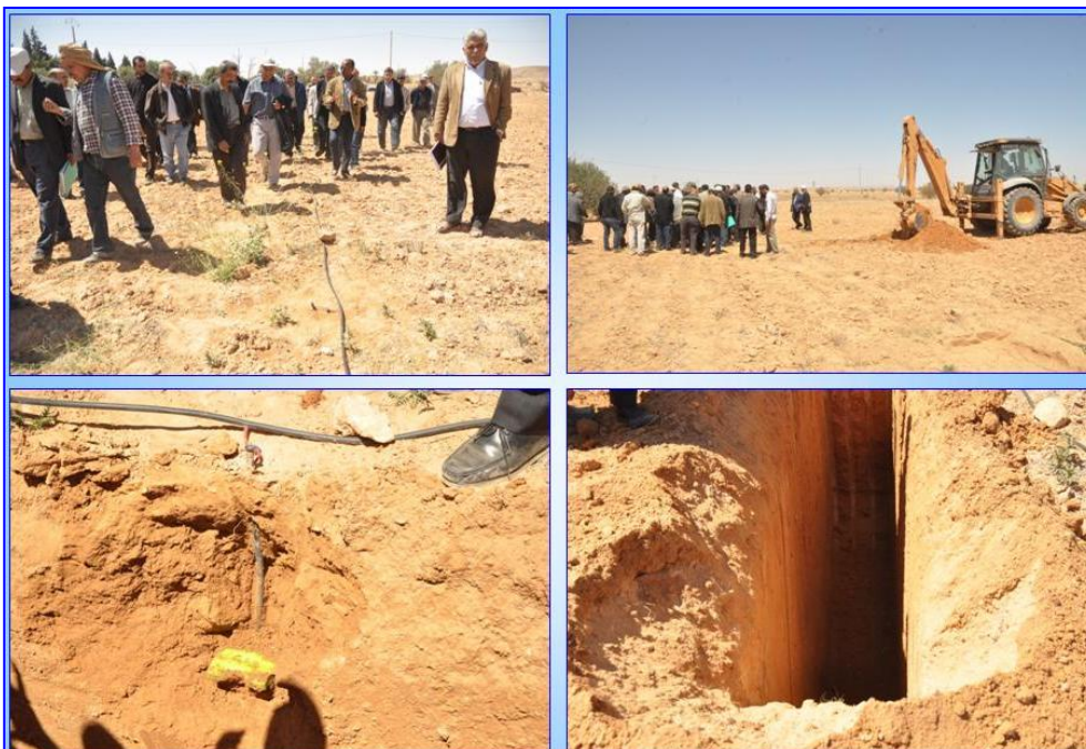
Essai d'injection d'eau (10 000 litres) dans les couches profondes du sol (sablo limono argileux) - Creusage de fossé pour montrer le bulbe d'humectation (6 mètres de diamètre et 2 mètres de profondeur)
